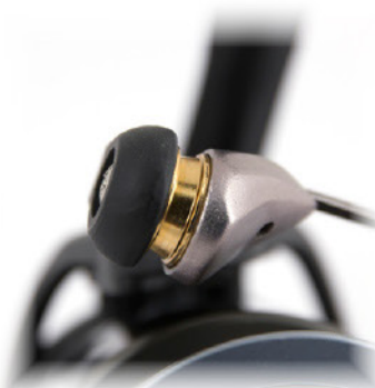
Galet de pick-up ne vrillant pas le fil
