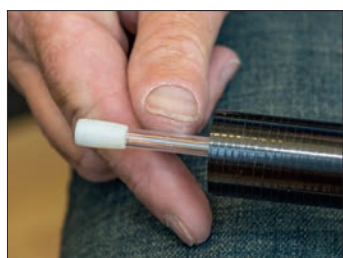
17. 50 mm trubičky vystupující z topsetu je tak akorát
