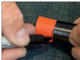
10. Inserire il "bung" all'interno della canna e segnare il punto in cui la sezione corrisponde perfettamente
