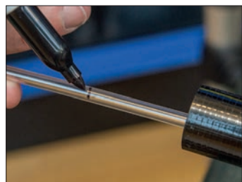
13. Inseritelo all'interno della canna e fate un segno sullo stelo a seconda di quanto volete tenerlo fuori
