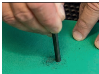
6. Utilizzando carta abrasiva, rimuovete eventuali residui rimasti sul bordo dopo il taglio
