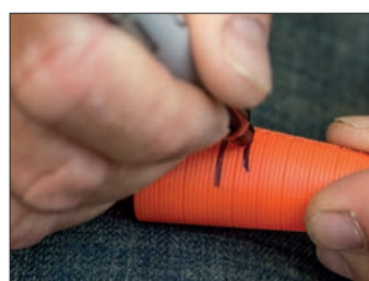
11. Pour marquer l'endroit de la découpe, marquez une ligne 5mm au-dessus de la précédente
