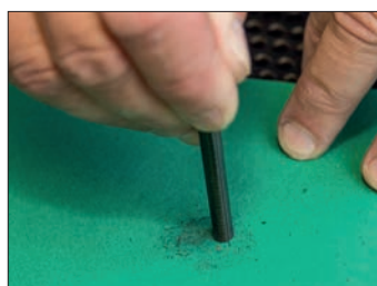
6. Passez l'embout au papier de verre fin afin d'adoucir les bords
