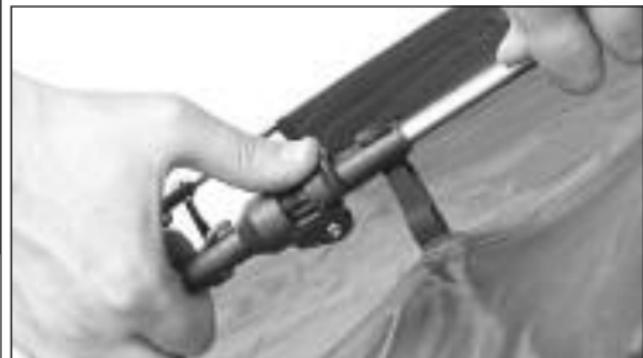
10. Der Abbau sollte an der Frontstange beginnen. Um die Verbindungen zu lösen, müssen sie die Stange knapp oberhalb der Verbindungsstellen nach innen drücken, um so die Spannung wegzunehmen. Schieben sie nun den Riegel der Verbindung nach unten und lassen sie sie aufklappen.
