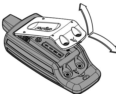
4. Für optimalen Feuchtigkeitsschutz sicherstellen, dass die Batterieabdeckung eine gute Abdichtung aufweist, dazu die Lippe fest in die obere Kante des Gehäuses drücken und dann in Position schieben.
