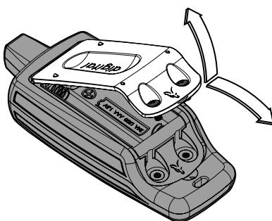
4. Aby zachować najlepszą odporność na warunki atmosferyczne, upewnij się, czy klapka baterii ma dobrą uszczelkę poprzez mocne docisnięcie jej do górnej krawędzi obudowy i właściwe dopasowanie.
