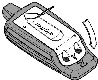
3. Zachowaj ostrożność podczas wyjmowania baterii.
