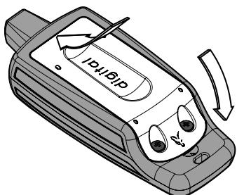
3. Fate attenzione nel rimuovere le batterie. Inserite quelle nuove facendo attenzione alla polarità.
