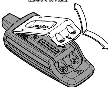
4. Для максимальной защиты от проникновения влаги плотно вставьте крышку в верхнюю часть отсека и надежно зафиксируйте ее в нужном положении.
