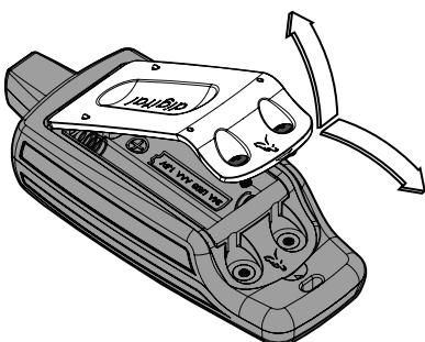
4. Per una efficace tenuta all'acqua, assicuratevi che la cover del vano batterie venga riposizionata correttamente nel corpo del Radiocomando, in modo che una volta avvitata possa garantire una sigillatura ottimale.
