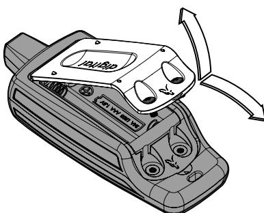
4. Voor optimale waterdichtheid, duw de rand van het batterijklepje stevig vast in de bovenzijde, en schuif in positie.
