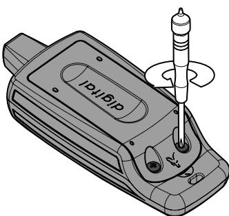
2. Pociągnij do góry dolną krawędź i zsuń ją, aby zdjąć klapkę baterii.
