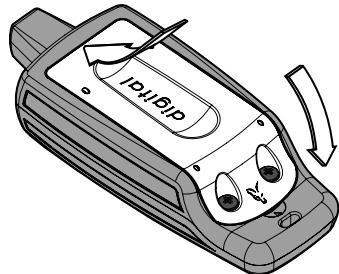
3. Scoateți bateriile cu grijă. Introduceți bateri noi, asigurându-vă că ați fixat corect bornele.
