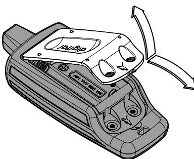
4. Pentru impermeabilizare perfectă, asigurați-vă că ați fixat ireproșabil capacul bateriilor prin poziționarea muchiei superioare în canalul dedicat și apăsare ușoară.
