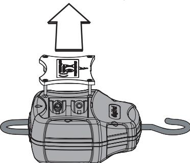
5. Reinstallare il cover e fissarlo con le viti.
