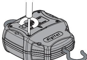
2. Przy pomocy śrubokręta należy odkręcić śrubki przytrzymujące klapkę baterii.
