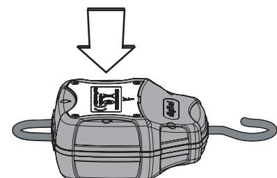
**Waarschuwing!** Draai de schroeven NIET te vast, excessieve kracht zal de Schroefdraad beschadigen.
