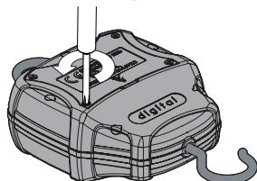
2. Utilisez un tournevis cruciforme afin de dévisser les vis du boîtier.
