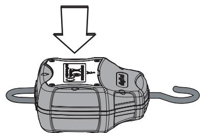
4. Fate attenzione nel rimuovere le batterie. Inserite le nuove assicurandovi che il verso (polarità) sia corretto.
